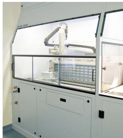
Enceinte Bigneat "BCEE" sous environnement contrôlé
